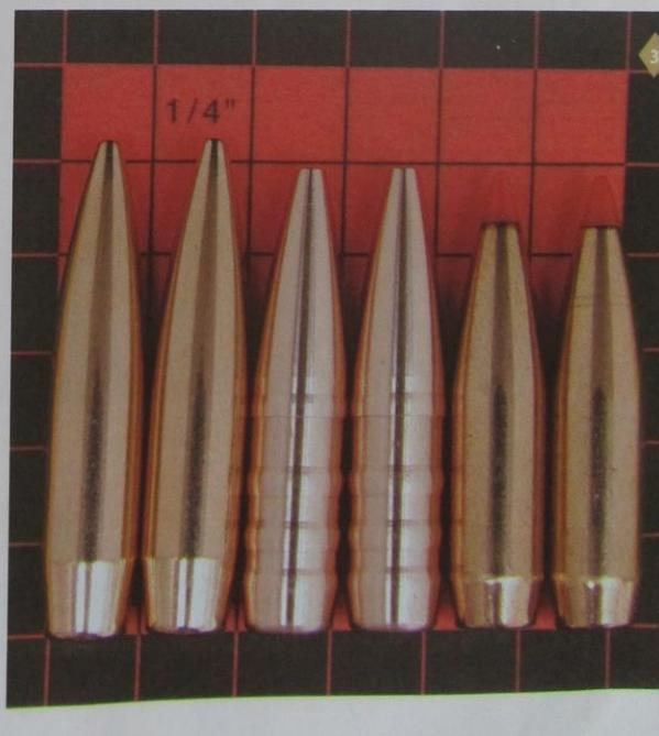
◀ La palla Hasler ha dato fino a oggi ottimi risultati su tutti i tipi di calibri e canne, con l'eccezione delle canne a rigatura poligonale, per le quali l'impiego di queste ogive è sconsigliato dallo stesso costruttore. La produzione avviene da
